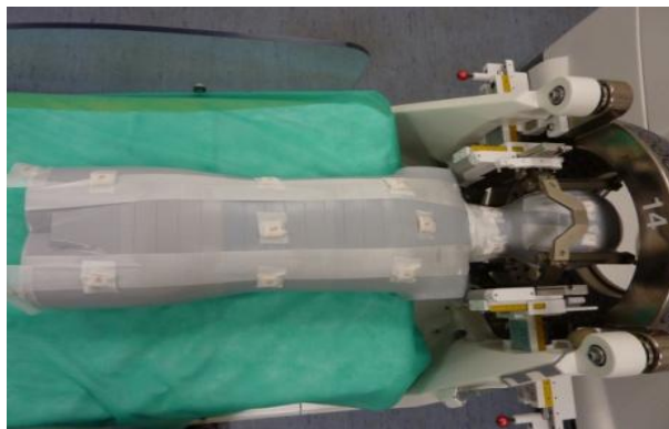
Slika 1. Fantom u položaju za GK radiokirurgiju s dozimetrima postavljenim na površini fantoma.
